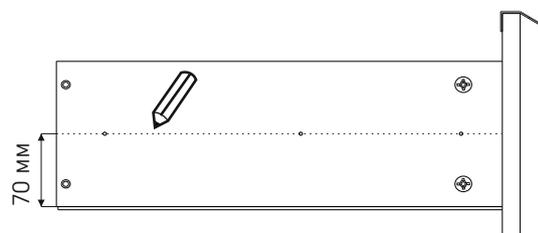
**2.2. Приложить** направляющую (п. 20.1) к каждой боковой стенке ящика так, чтобы центры отверстий направляющей совпали с линией на боковой стенке ящика, выдержав размеры, показанные на рисунке.
