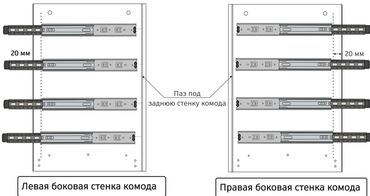
**3.4. Крепить** элементы направляющей (20.2) шурупами (п.24) в отверстия которые показаны на рисунке.
