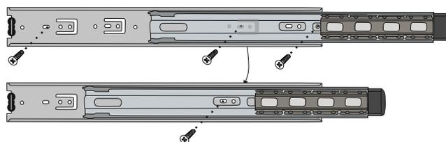
Отверстия в элементе направляющей для крепления на правую сторону перегородки
