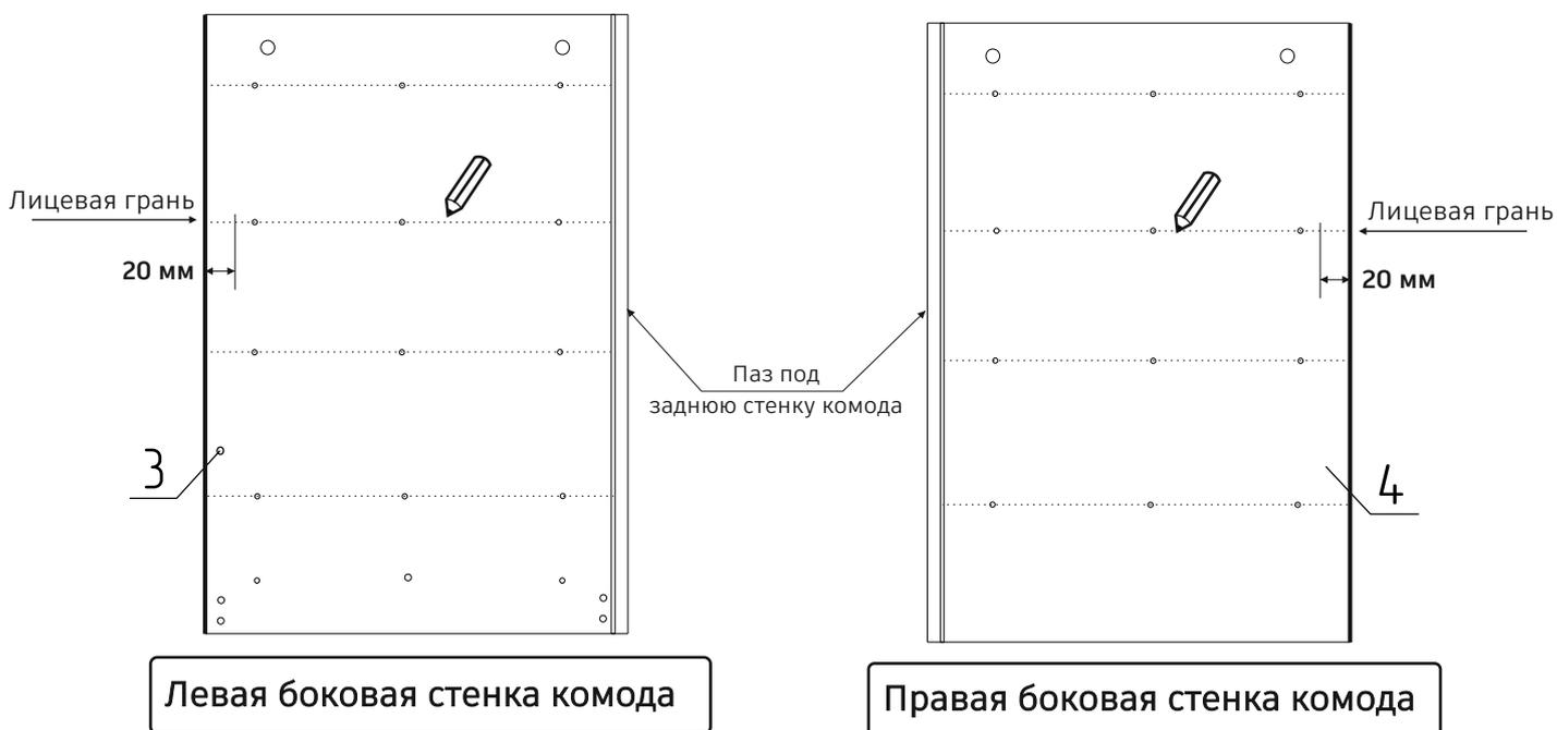
**3.3. Приложить** элементы направляющих которые крепятся к боковым стенкам комода (поз 20.2) так, чтобы центры отверстий направляющей совпали с нарисованной линией и отступая от передней грани боковой стенки **20мм**.
