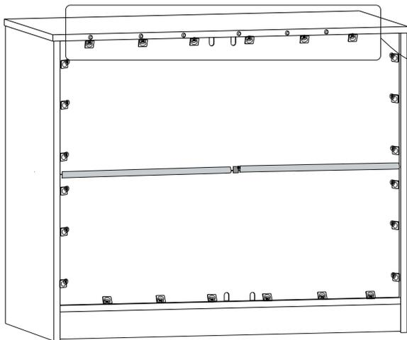
**Места для установки пеленального столика**, в зависимости от того как вам удобно установить столик будут задействованы 2 из 6 отверстий металлических шкантов поз 29.
