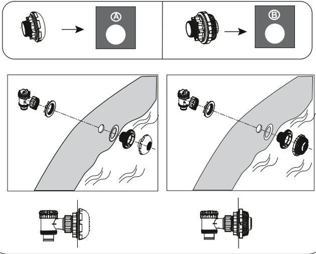
**OPMERKING:** Als u de andere zwembadreinigingskits wilt aansluiten op het zwembad via de aansluitingsklep, gebruik dan een kruiskopschroevendraaier om het vuil scherm te demonteren van de connector.
