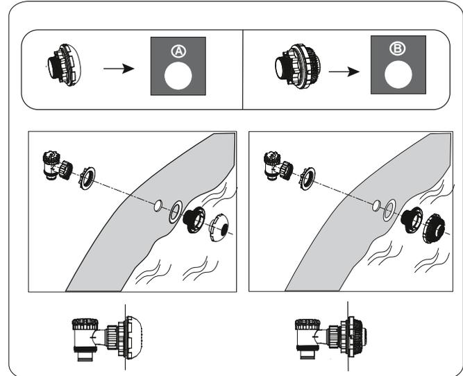
**HINWEIS:** Wenn Sie ein anderes Poolreinigungssetz über das Anschlussventil anschließen möchten, verwenden Sie einen geeigneten Schraubendreher, um das Schmutzsieb von dem Anschluss abzumontieren.
