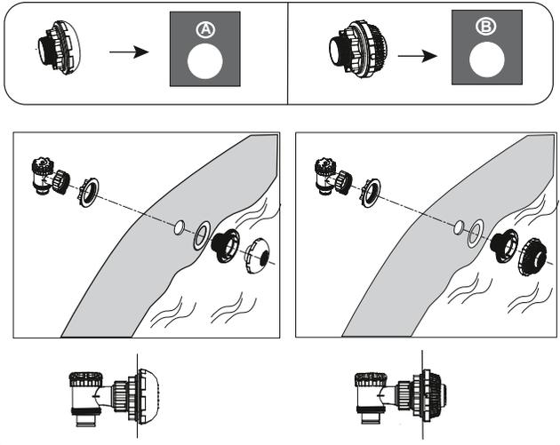
**MEGJEGYZÉS:** Ha más medencei tisztítókészleteket szeretne csatlakoztatni a csatlakozószelepen keresztül, csillagszavarrhúzóval válassza le a törmelékzsűrőt a csatlakozóról.
