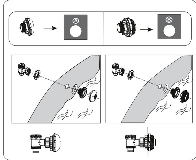
**ΣΗΜΕΙΩΣΗ:** ΕΑΝ ΕΠΙΘΥΜΕΙΤΕ ΝΑ ΣΥΝΔΕΣΕΤΕ ΑΛΛΑ ΚΙΤ ΚΑΘΑΡΙΣΜΟΥ ΠΙΣΙΝΑΣ ΣΤΗΝ ΠΙΣΙΝΑ ΜΕΣΩ ΤΗΣ ΒΑΛΒΙΔΑΣ ΣΥΝΔΕΣΗΣ, ΧΡΗΣΙΜΟΠΟΙΗΣΤΕ ΕΝΑ ΣΤΑΥΡΟΚΑΤΑΒΙΔΟ ΓΙΑ ΝΑ ΑΠΟΣΥΝΑΡΜΟΛΟΓΗΣΤΕ ΤΗ ΣΗΤΑ ΥΠΟΛΕΙΜΜΑΤΩΝ ΑΠΟ ΤΟ ΣΥΝΔΕΣΜΟ.
