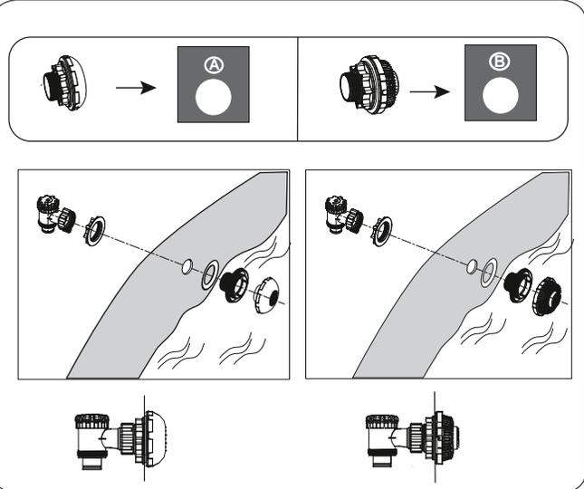
**OBS!** Om du vill ansluta andra poolrengöringsutrustningar till poolen genom anslutningsventilen ska du använda en Phillips skruvmejsel för att ta isär skräpnätet från anslutaren.
