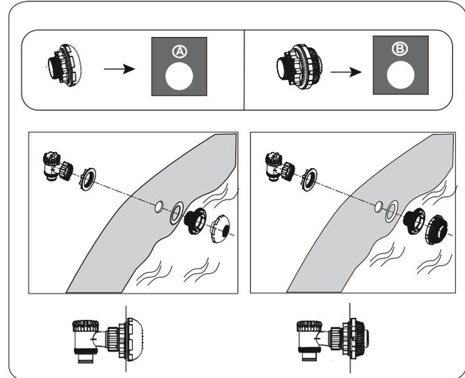
**NOTA:** Se si desidera collegare altri kit di pulizia della piscina alla piscina stessa attraverso la valvola di collegamento, utilizzare un cacciavite Phillips per smontare il filtro per detriti dal connettore.
