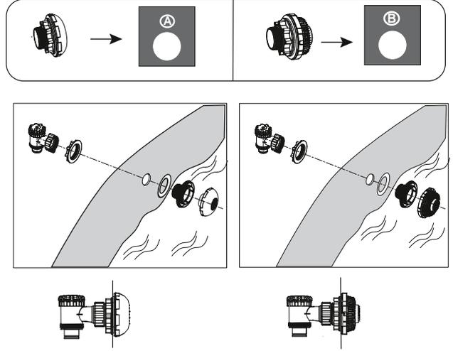
**NOTA:** Caso pretenda ligar outros kits de limpeza de piscina à piscina através da válvula de ligação, utilize uma chave de parafusos Phillips para desmontar o Filtro de Detritos do Conector.
