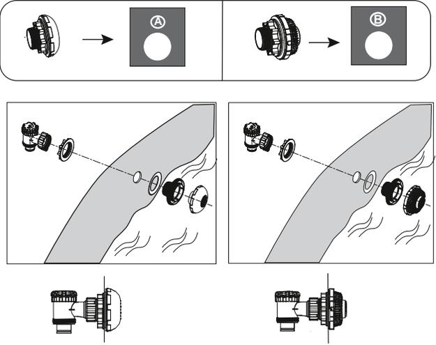
**ПРИМЕЧАНИЕ:** Если вы хотите подсоединить другие комплекты для чистки бассейнов через соединительный клапан, с помощью отвертки Phillips снимите с соединителя сетку для улавливания мусора.
