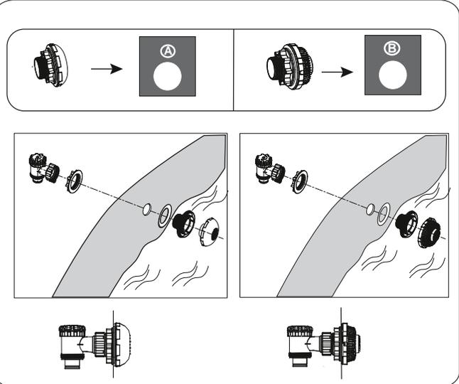
**NOTA:** Si desea conectar otros kits de limpieza de piscinas a la piscina a través de la válvula de conexión, use un destornillador Phillips para desmontar la Rejilla para residuos del conector.
