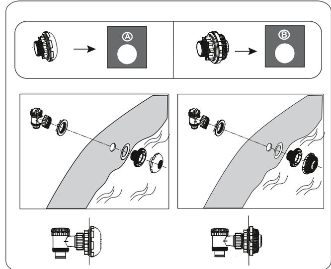
**UWAGA:** W celu podłączenia do zaworu połączenia basenu innych zestawów czyszczących, użyj śrubokręta krzyżowego w celu odkręcenia od niego filtra siatkowego.
